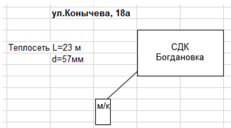
Рисунок 1.3.2.3 – Схема тепловых сетей модульной котельной с. Богдановка, ул. Конычева, 18А
