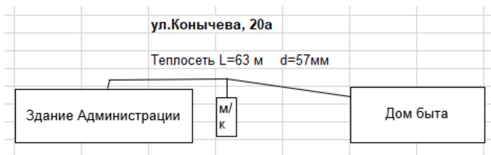
Рисунок 1.3.2.1 – Схема тепловых сетей модульной котельной с. Богдановка, ул. Конычева, 20А, ООО «Уют»
