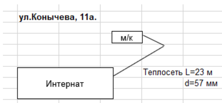
Рисунок 1.3.2.2 – Схема тепловых сетей модульной котельной с. Богдановка, ул. Конычева, 11А
