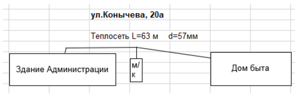
Рисунок 1.3.2.1 – Схема тепловых сетей модульной котельной с. Богдановка, ул. Коннычева, 20А, ООО «Уют»
