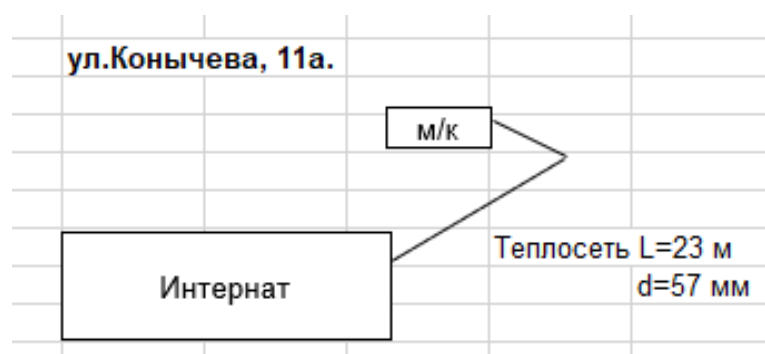
Рисунок 1.3.2.2 – Схема тепловых сетей модульной котельной с. Богдановка, ул. Коннычева, 11А
