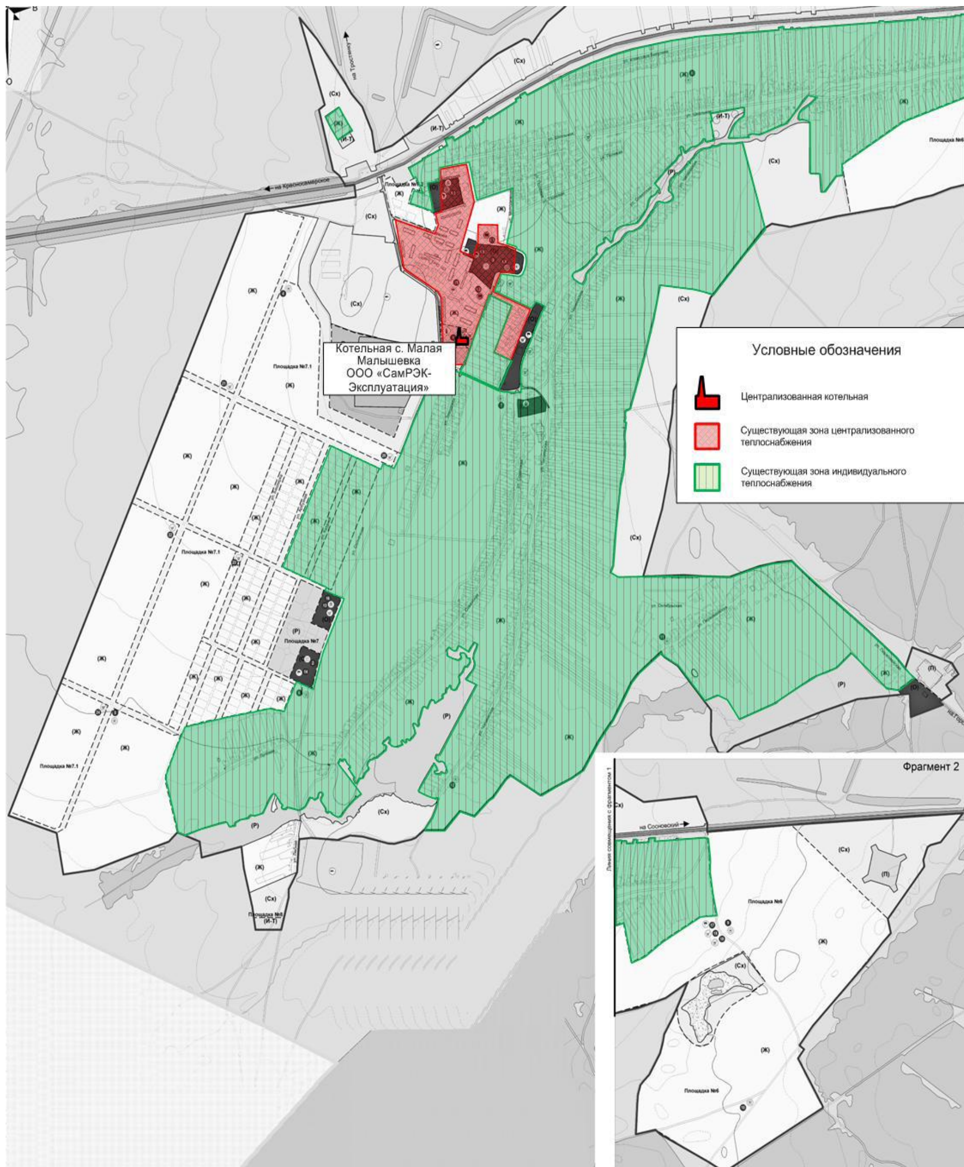
Рис. № 9 – Зоны действия существующих индивидуальных источников тепловой энергии, находящихся в частной собственности жителей села Малая Малышевка
