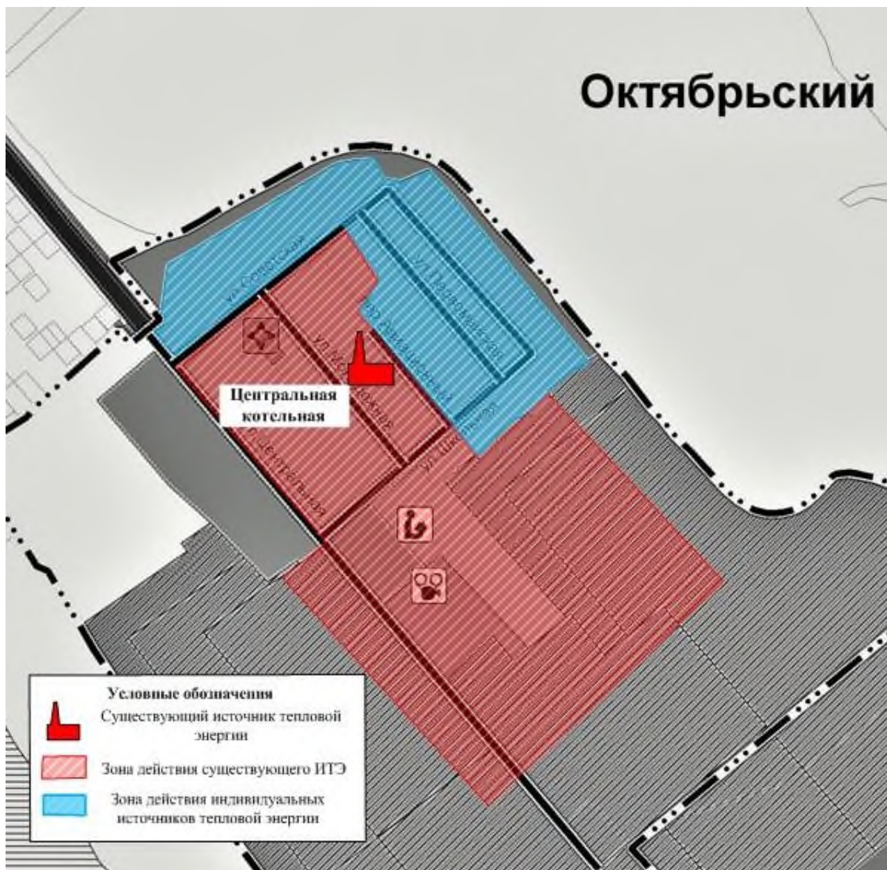
Рис. № 4 - Зоны действия централизованной котельной и индивидуальных источников тепловой энергии ИЖД на территории поселка Октябрьский
