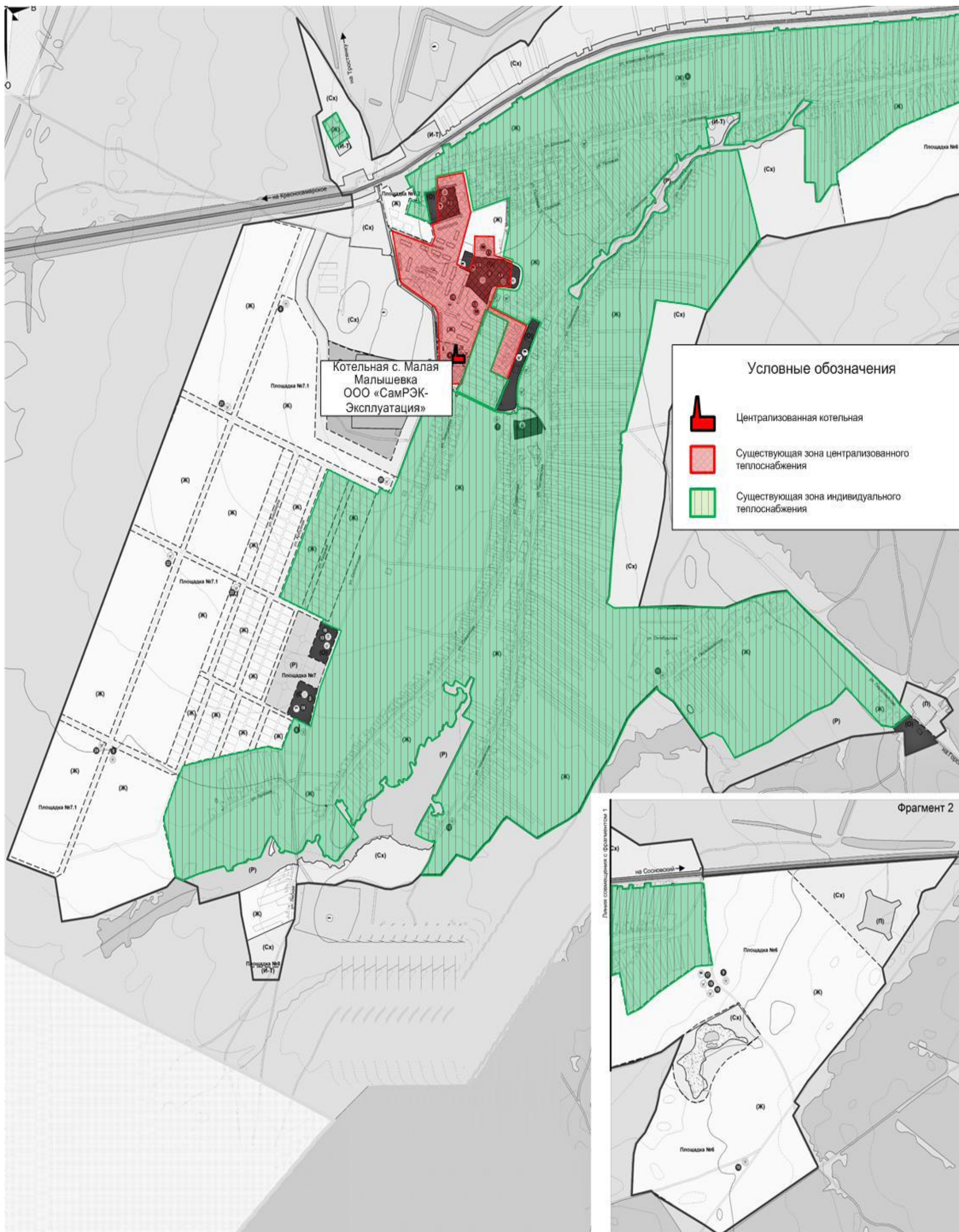
Рис. № 2 - Зоны действия централизованного и индивидуальных источников тепловой энергии на территории села Малая Малышевка
