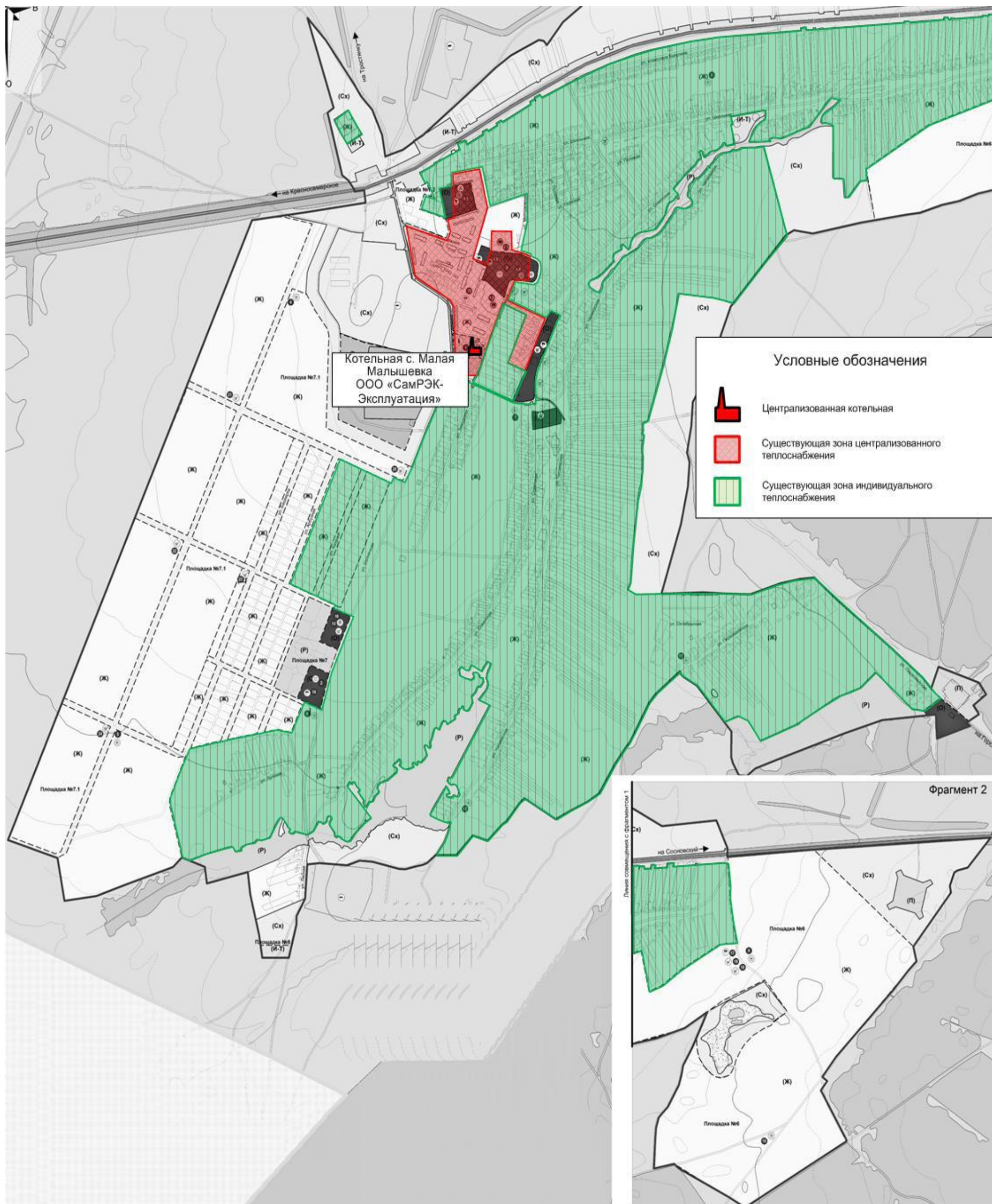
Рисунок № 7 – Зоны действия централизованной системы теплоснабжения и индивидуальных источников тепловой энергии, находящихся в частной собственности жителей села Малая Малышевка
